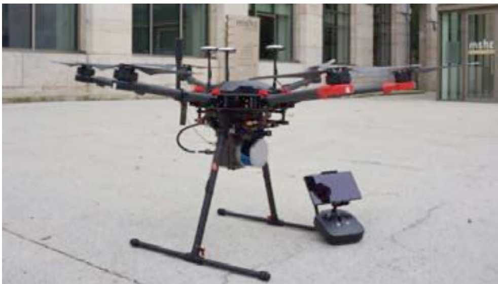
Fig.2 Système d'acquisition LiDAR aéroporté : Matrice 600 Pro et capteur LiDAR Lynx 16
