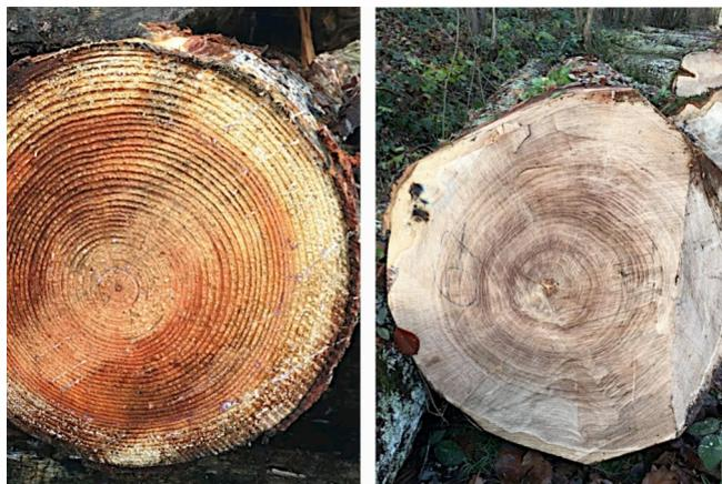
**Fig. F 21** - Coupe d'un résineux (bois tendre) à gauche et d'un feuillu (bois dur du chêne) à droite (photo : Sylviane Delpech).
