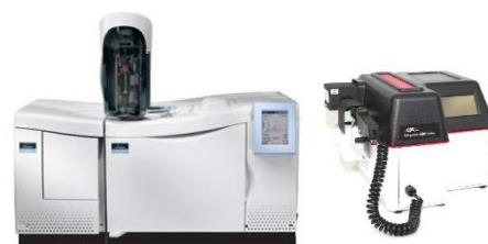
Fig.2. Couplage Pyrolyse/GCMS
