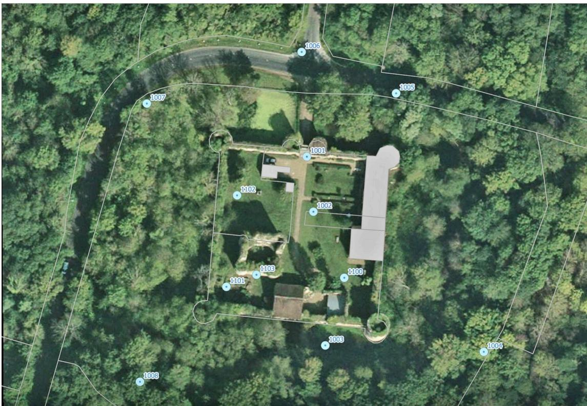
**Fig. C 03** - Situation des points topographiques créés sur fond de plan Géoportail et cadastre (DAO : Georgia Reosch / ADM).
