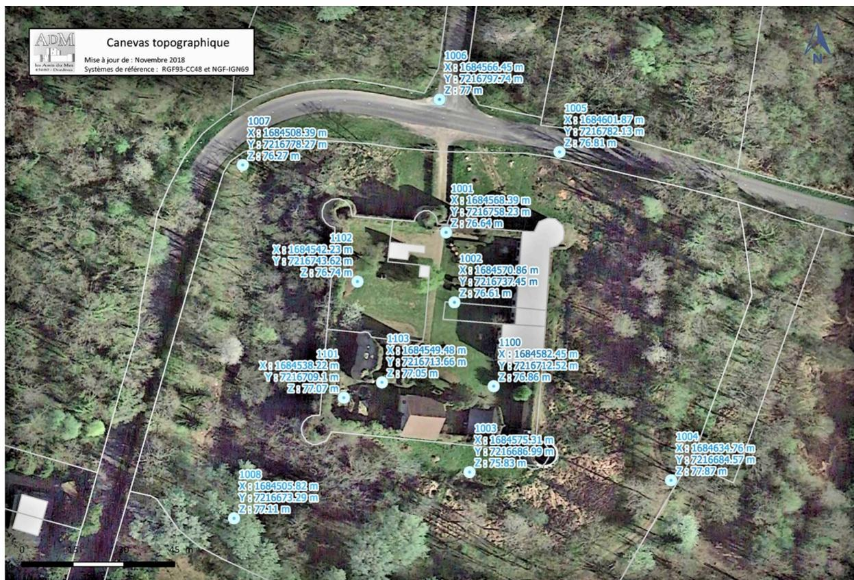
**Fig. C 10** - Coordonnées et altimétries des points topographiques (DAO : Georgia Roesch / ADM)
